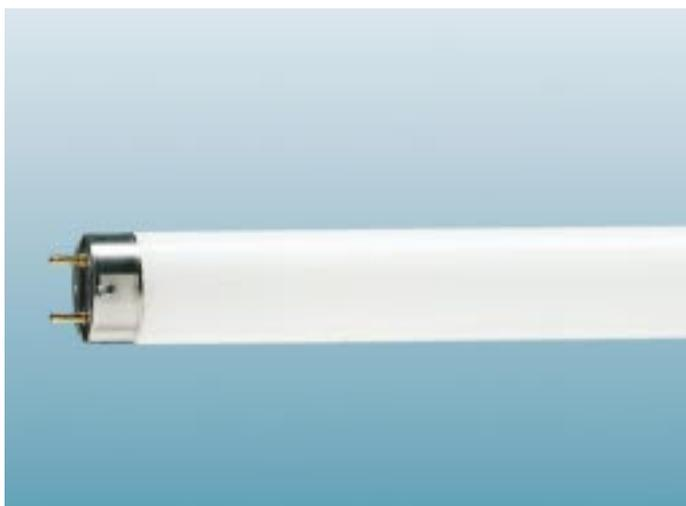
Lampade fluorescenti lineari a scarica in gas a bassa pressione ad arco lungo, costituite da un bulbo tubolare in vetro chiaro di 26 mm di diametro, rivestito internamente con polveri fluorescenti bifosforo, e provviste di attacco G13. Disponibili nelle potenze da 18 a 58W ed in varie tonalità di colore
